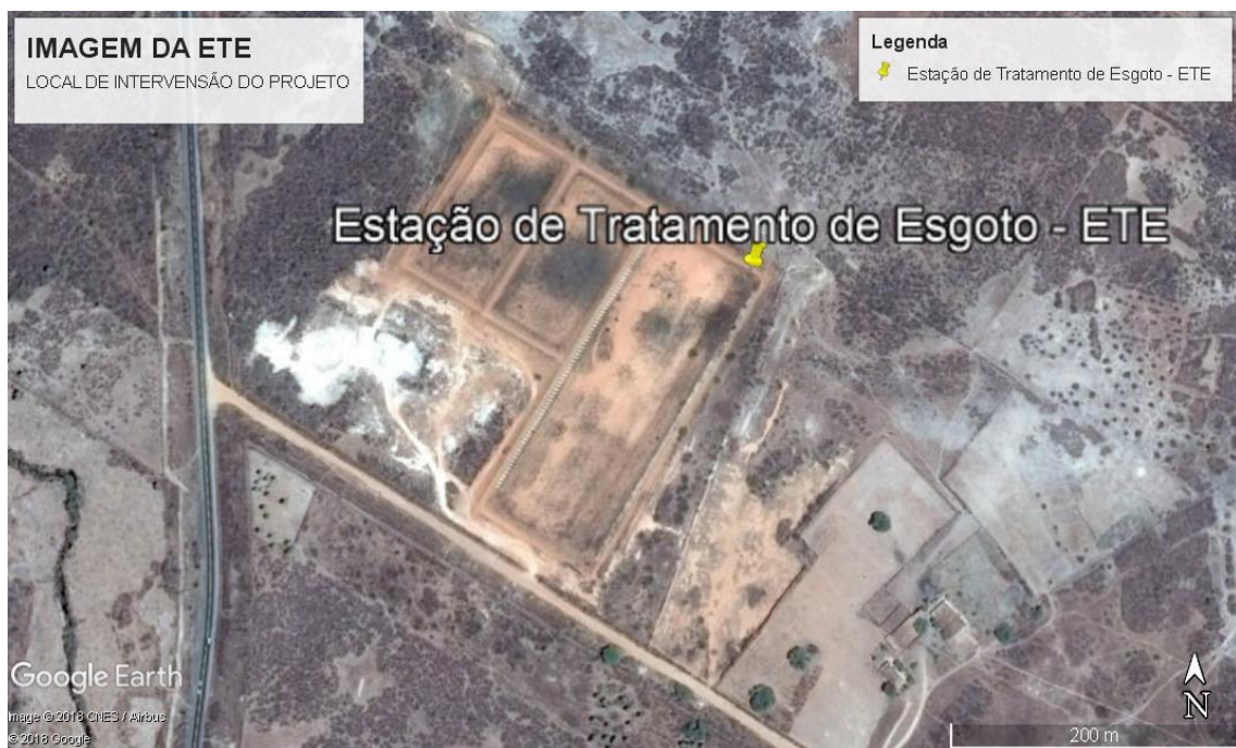
Figura 3 – Imagem de Satélite – Estação de Tratamento de Esgoto – ETE, conjunto de três lagoas de estabilização, uma facultativa e duas de maturação
