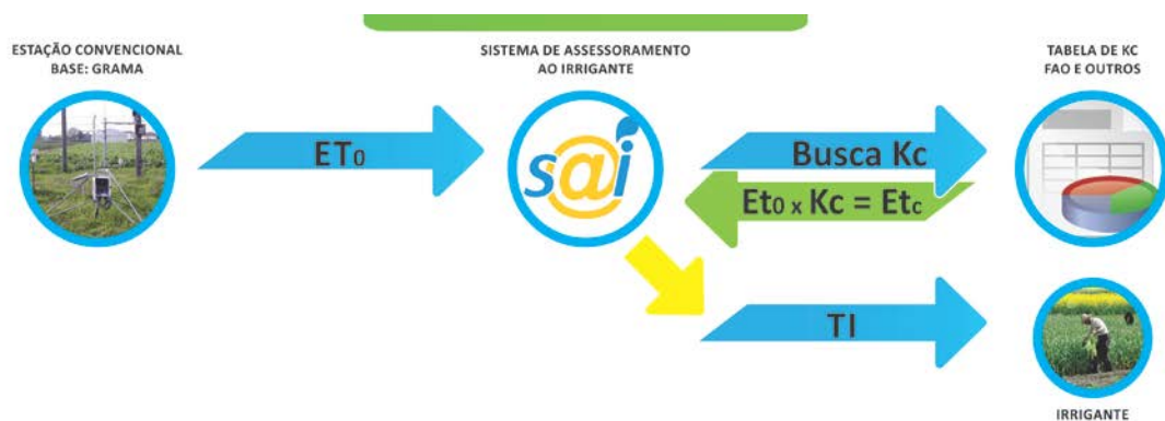
Modelo de determinação da ETC e do Tempo de Irrigação (TI) pelo Sistema S@I.
