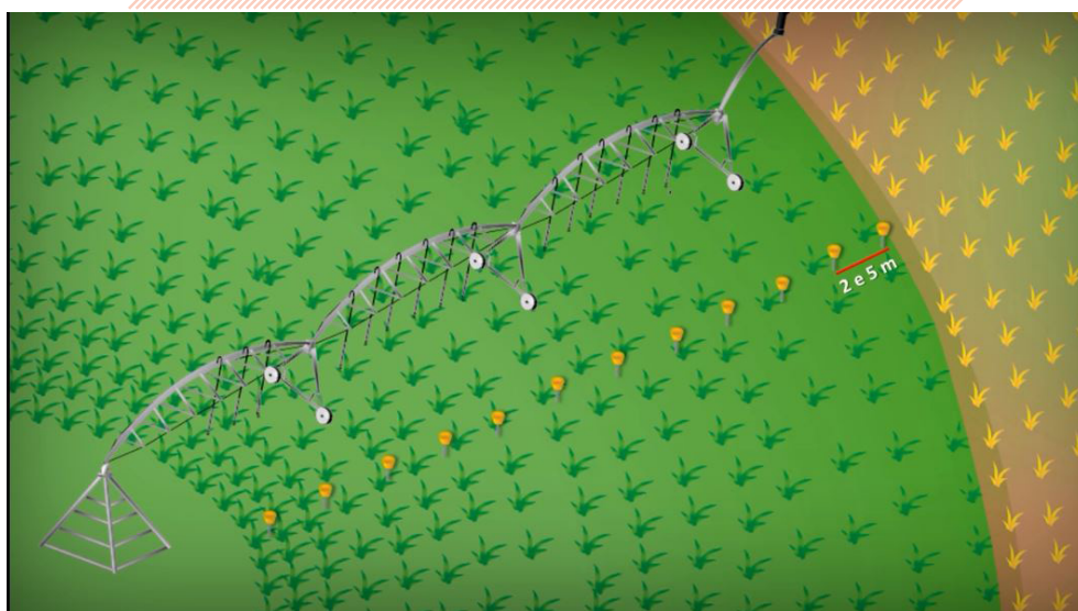
Figura 12 - Distribuição dos coletores ao longo da linha lateral para avaliação da uniformidade do pivô.
