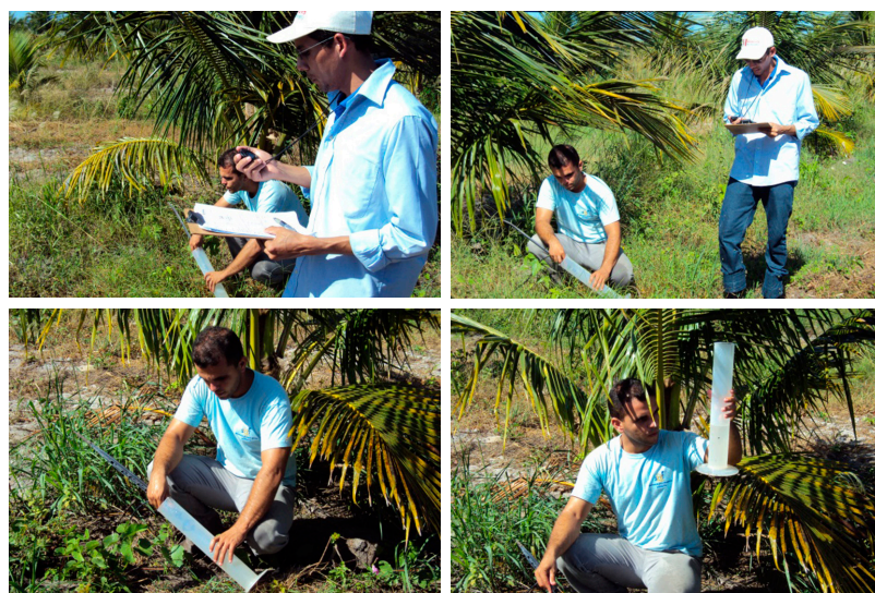
Figura 18 - Exemplo de leitura de vazão de um microaspersor em campo
