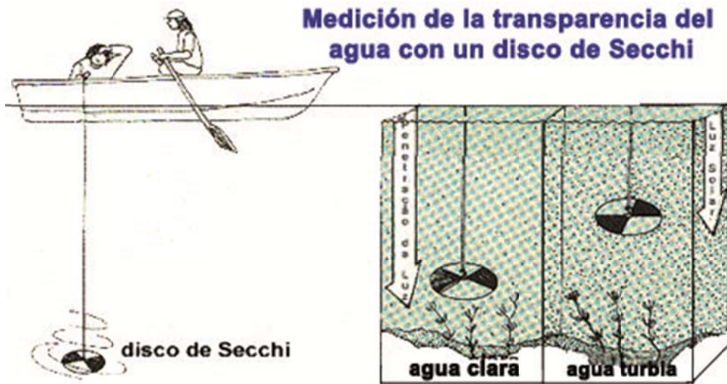
Figura 35 B. Esquema de la medición de la transparencia del agua con un disco de Secchi.
