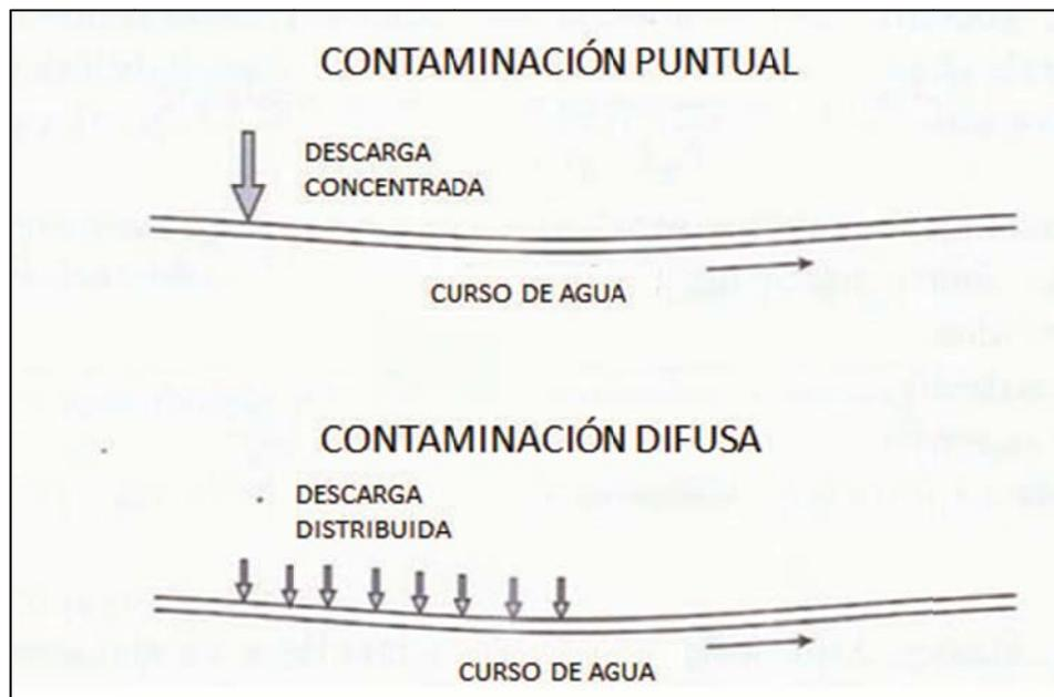
**Figura 21.** Fuentes de polución puntual y difusa y ejemplos de puntos para muestreo de agua (adaptado de Von Sperling 2005).
