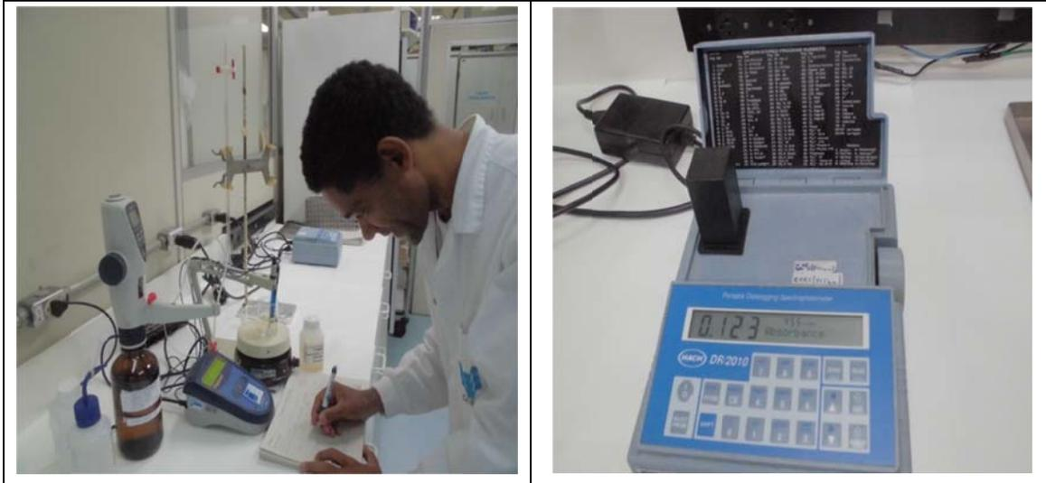
**Figura 2.** Procedimiento para determinación del color en el espectrofotómetro del Laboratorio de Química Inorgánica de la CETESB. Foto: R. Rossetti (2017)
