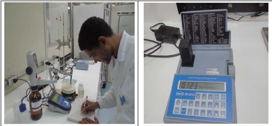
**Figura 2** - Procedimento para determinação da cor no espectrofotômetro do Laboratório de Química Inorgânica da CETESB Foto: R. Rossetti (2017)
