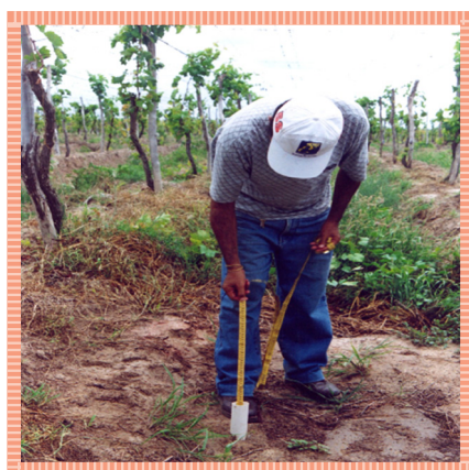
Figura 4 - a) Medição do nível do lençol freático, b) Leitura da profundidade do nível estático
